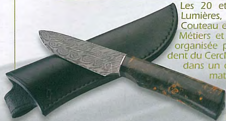
Guy Poggetti : Couteau de chasse au manche en loupe d'orme. Lame en damas explosion (15N20/90MCV8)
